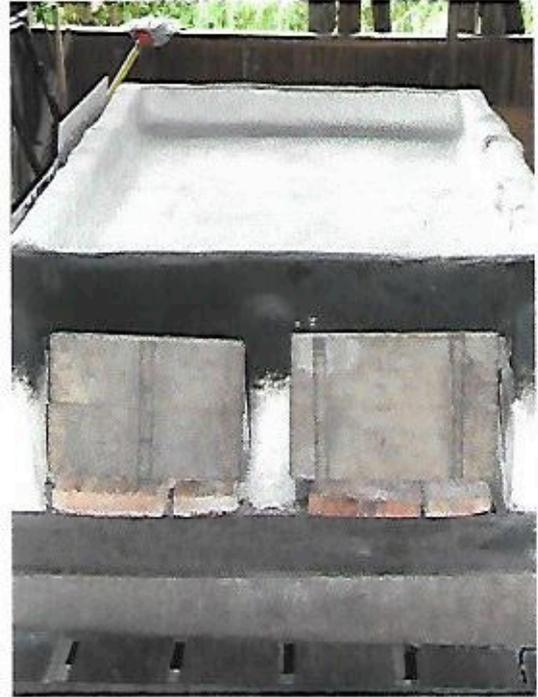
Les boulettes sont ensuite mises à sécher au dessus d'un four à bois. L'aire de séchage est volontairement large et peu profonde de façon à favoriser une dessiccation homogène.
